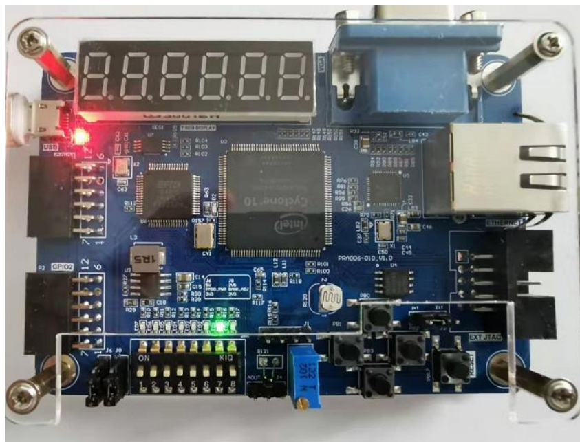
图 1-27 流水灯实验现象
