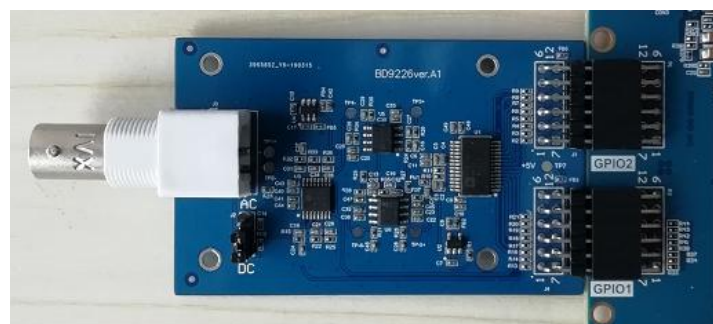
图 13-4 GPIO 接口搭配 BD9226 高速 AD 子板
