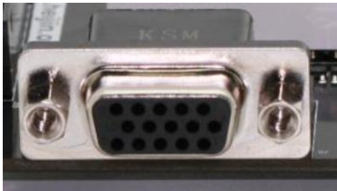
图 5-5 VGA 接口实物图
